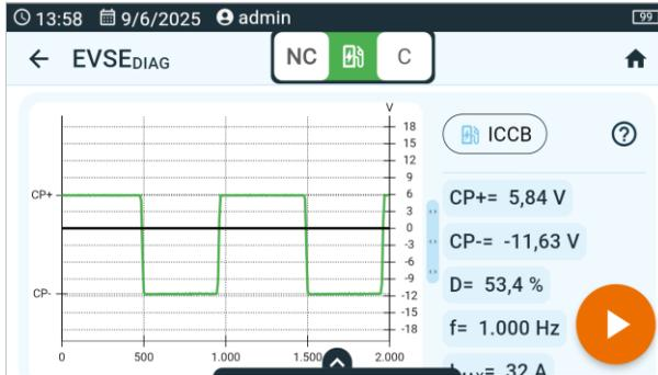
**CP+, CP-** : tensiones de las formas de onda de la señal CP medidas en relación con la referencia. Permiten evaluar la corrección de la comunicación entre el EVSE y el vehículo conectado.
